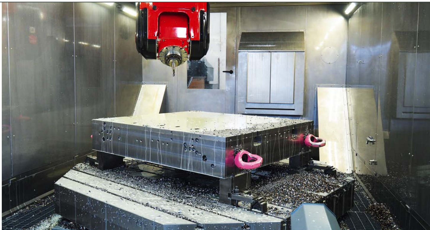
Blick in die Trimill VU 3021: In der HSC-Portalfräsmaschine werden Formen bis 15 Tonnen bearbeitet. (© Hanser/Schröder)
