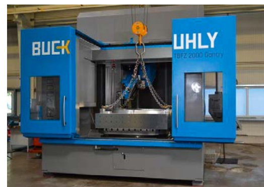
Tiefbohren bis 2 m Länge: Lohndienstleistung ist das zweite wichtige Standbein von Buck Formenbau. Zum Schrappen und Tiefbohren kommt die BuckUhly TBFZ-G 2000 zum Einsatz. (© BuckUhly)
