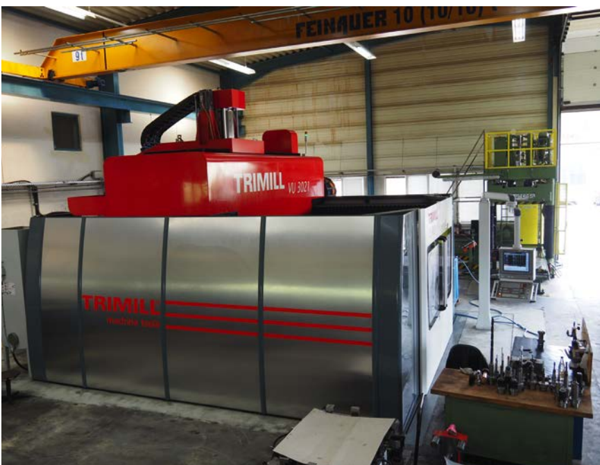
In ganzer Größe: die Gantrymaschine Trimill VU 3021 (© Hanser/Schröder)
